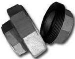
**9.- REDUCCIÓN CAMPANA:** Cumple con la misma función de el Cople solo que une con medidas distintas, cabe aclarar que si es en acero forjado o se llama cople reducido, si es soldable, rasurado o brindado, se le llama reducción concéntrica y cuando sus extremos son roscados se llama reducción campana pero todos cumplen la misma función solo es cuestión de semántica. °
